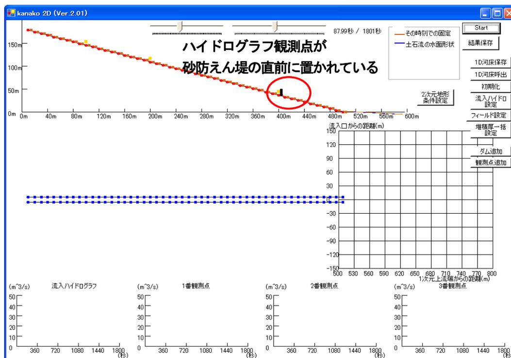
図 57 入力画面（ハイドログラフ観測点が砂防えん堤の直前に置かれている）
